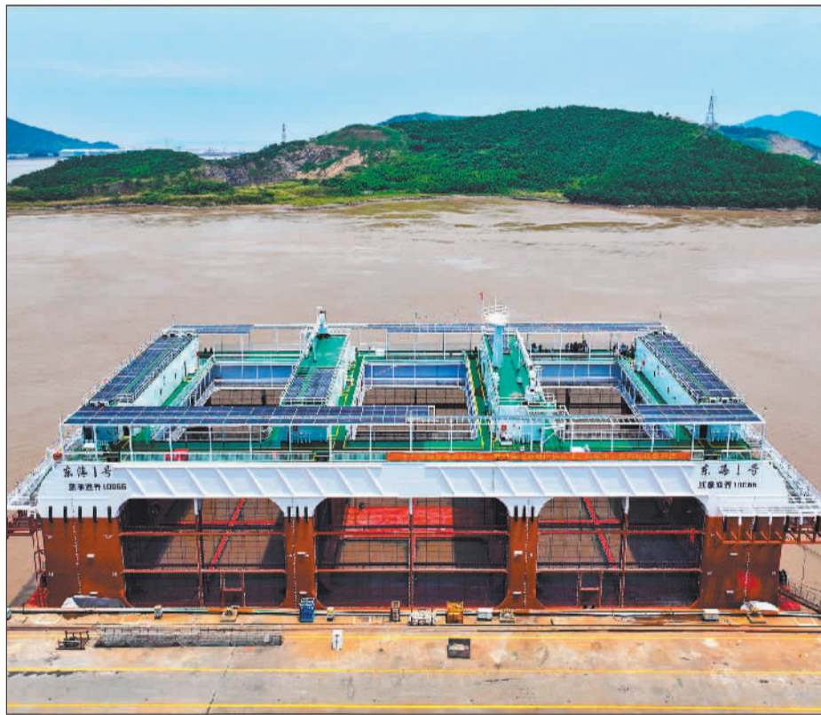
▲7月10日,浙江首座深远海半潜式养殖平台在宁波正式交付。该平台在海上可利用波浪能和光伏发电等方式实现能源自给自足,同时配备了智能化养殖信息系统,能进行远程操控和自动投喂。 胡学军摄(中经视觉)
