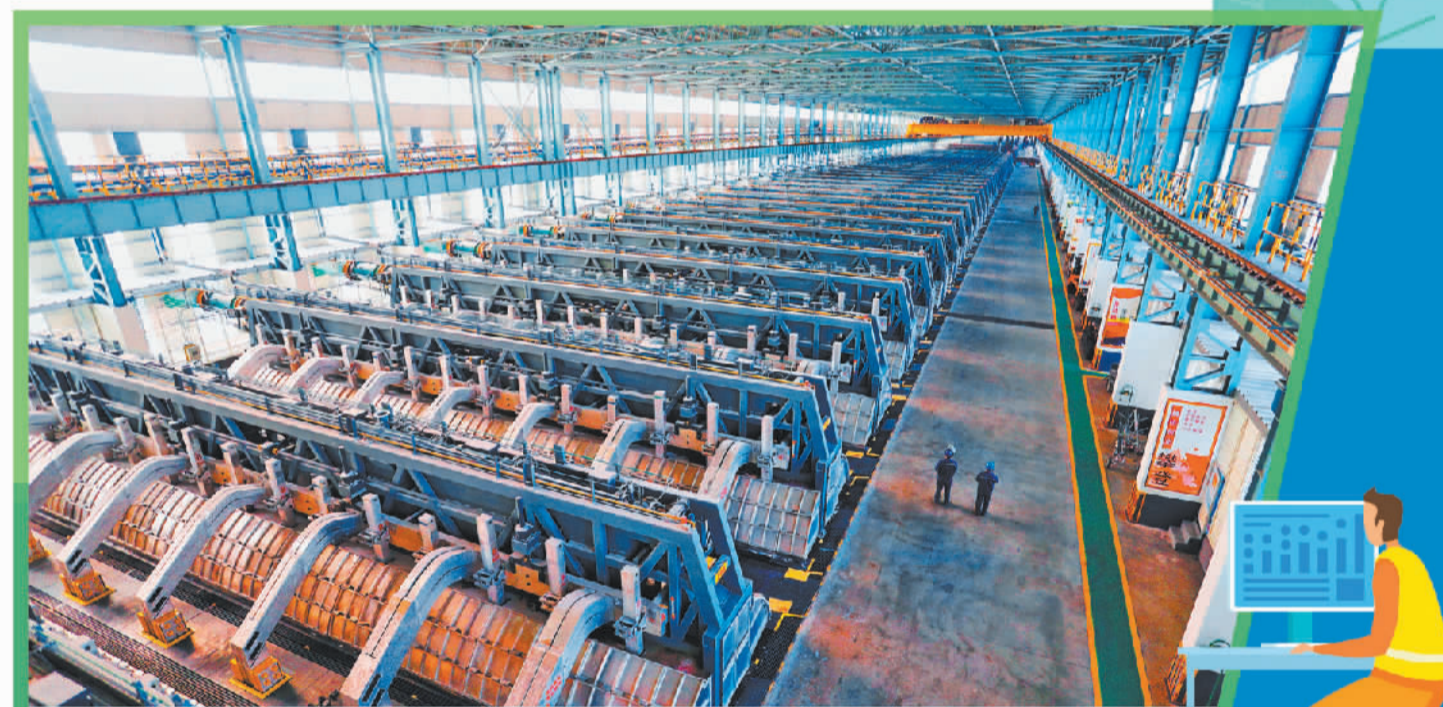
魏桥集团600千安特大型阳极预焙电解槽生产线。
