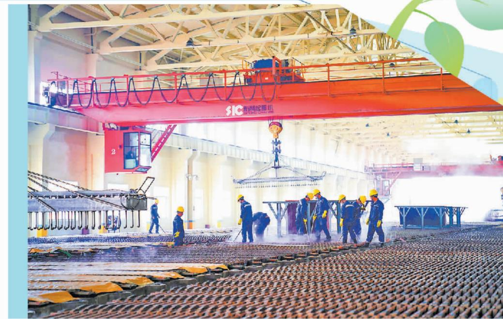
自立公司电解生产车间,工人把铜板放在浸出液中进行电解。 陈强摄(中经视觉)
