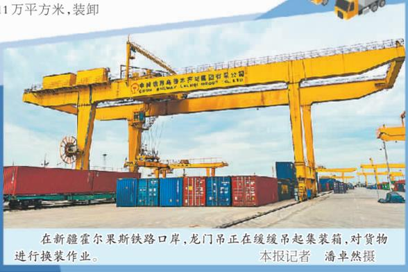
在新疆霍尔果斯铁路口岸,龙门吊正在缓缓吊起集装箱,对货物进行换装作业。 本报记者 潘卓然撰
