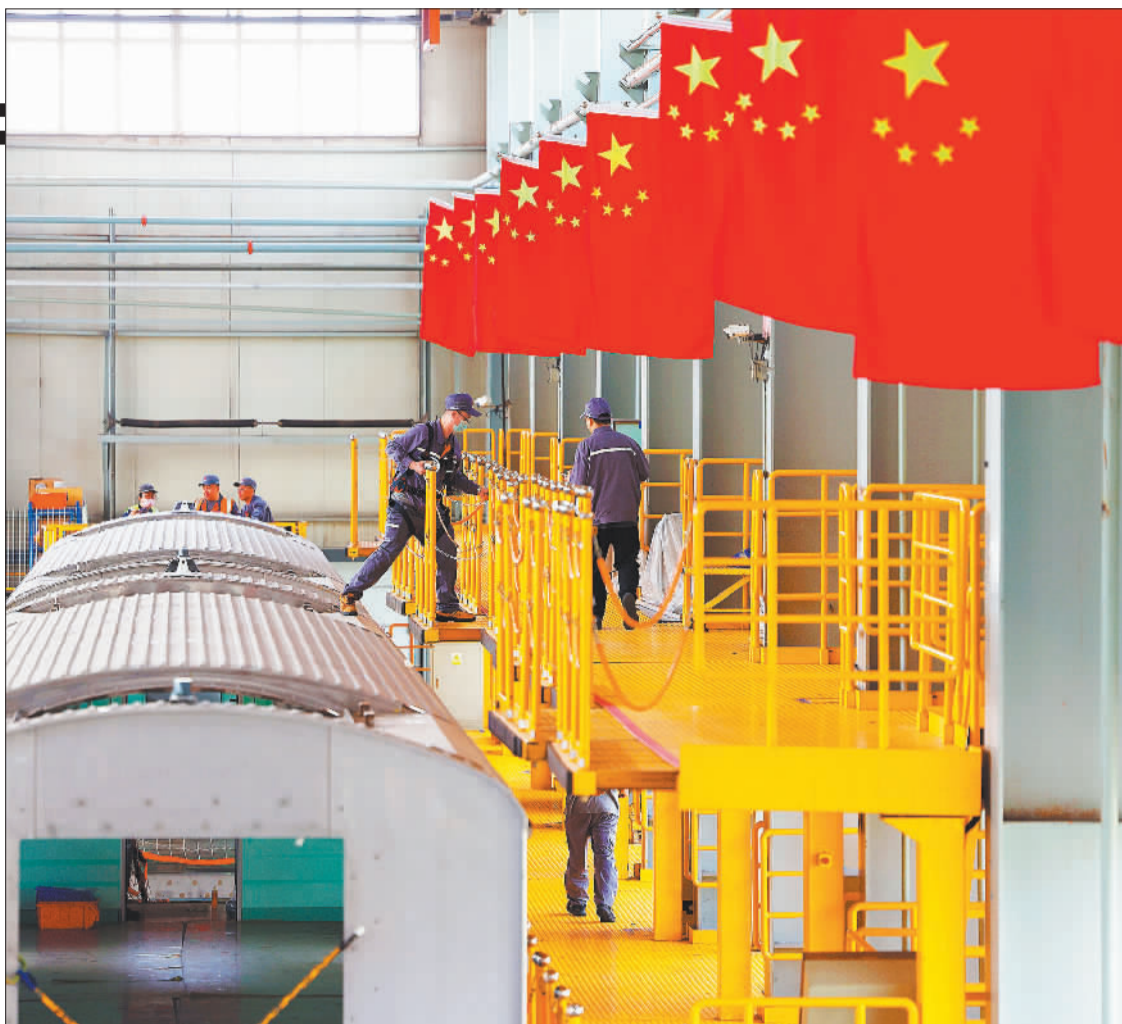
▲5月28日,中车长客城铁事业部制造中心装配产线组,员工在进行地铁车辆车顶布线作业。
