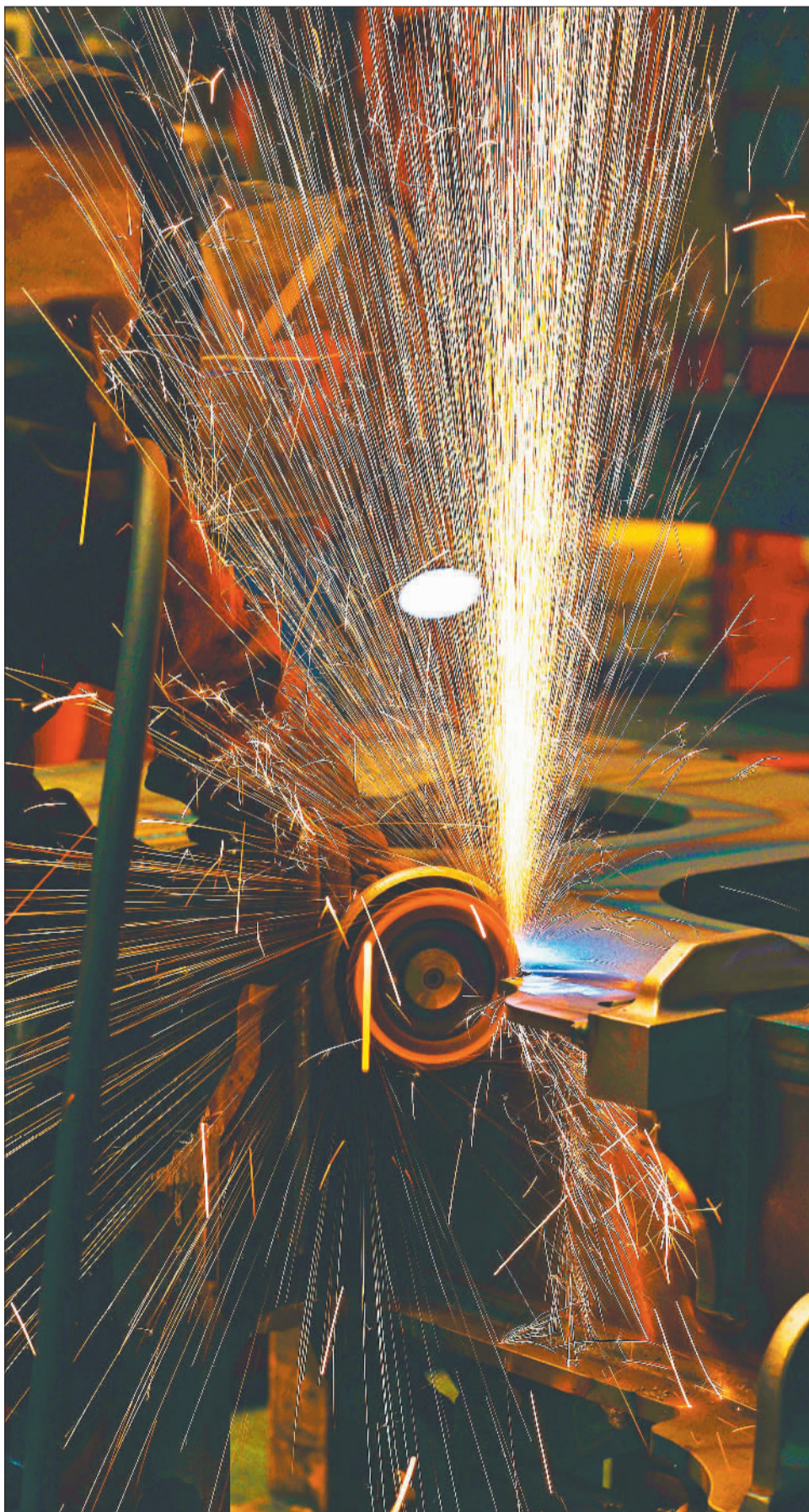
▼5月28日,中车长客转向架事业部焊接产线组,员工在进行动车组构架横梁焊后修磨作业。
