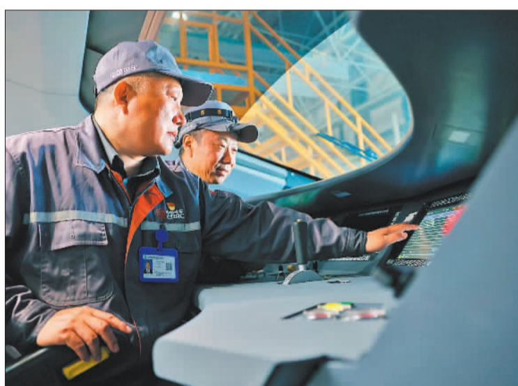
▲5月28日,中车长客城铁事业部制造中心装配产线组,员工在进行地铁车辆车顶布线作业。
