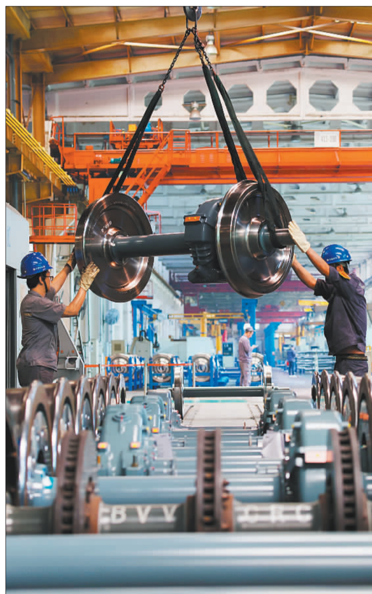
▼5月28日,中车长客转向架事业部总成产线组,员工在进行城轨轮对压装作业。
