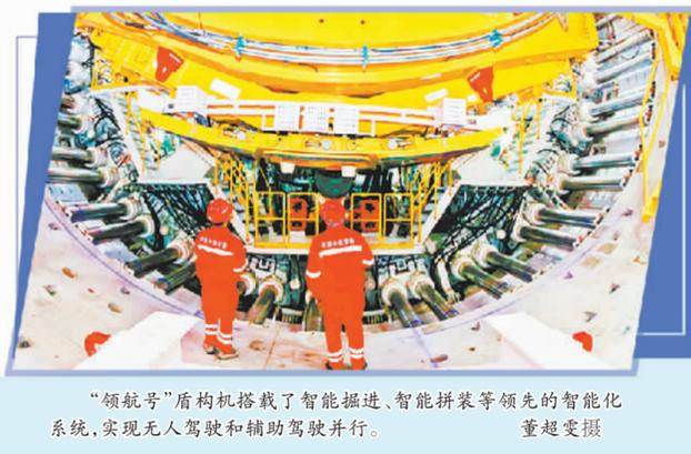
“领航号”盾构机搭载了智能掘进、智能拼装等领先的智能化系统，实现无人驾驶和辅助驾驶并行。董超变摄
