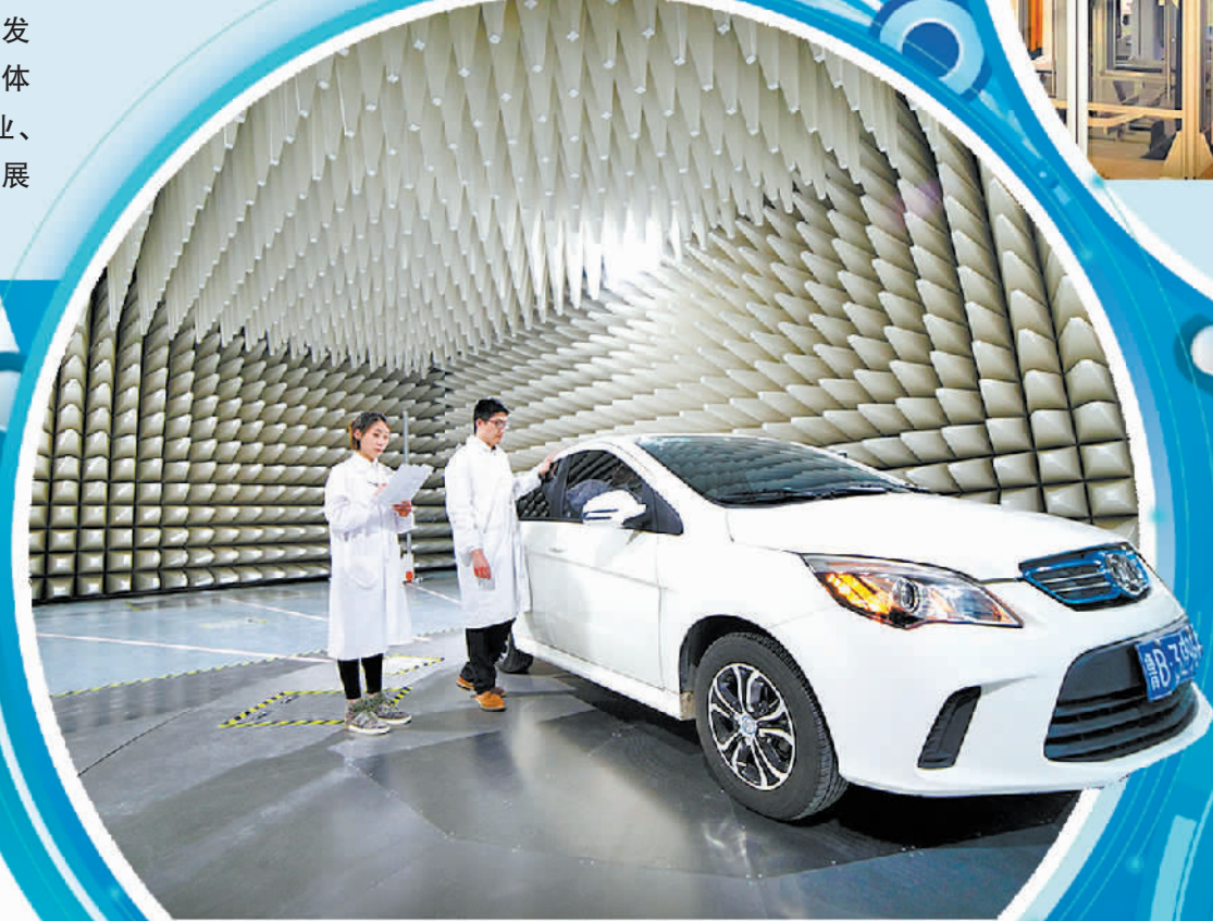
工作人员在青岛海检中心电磁兼容实验室对汽车辐射发射进行测试。(资料图片)
