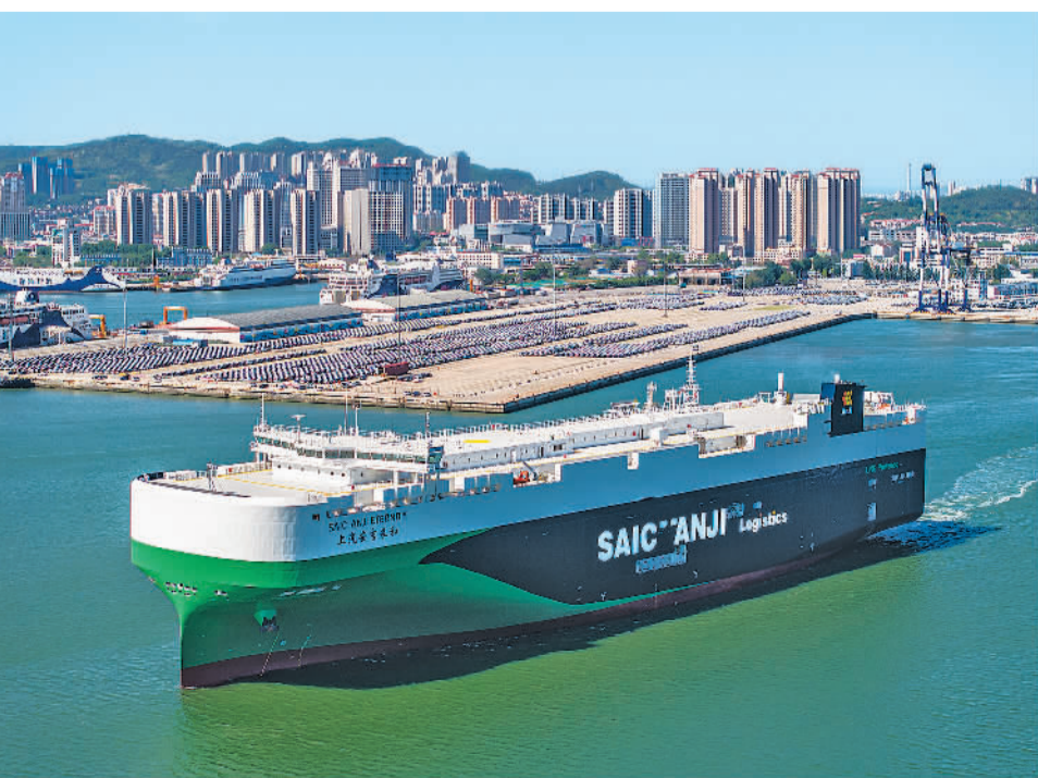
近日,由中集来福士为国内车企建造的清洁能源滚装船“上汽安吉和”轮在山东烟台港正式交付并首航发运。该船总长199.9米,额定装载量为7000车,以清洁环保的液化天然气为主要燃料,是新一代环保型船舶。
