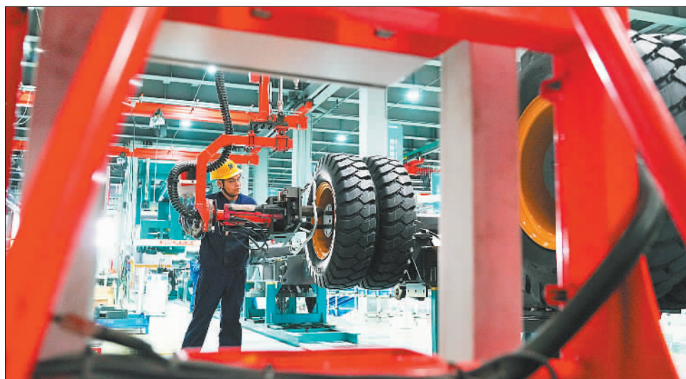
▼5月8日,徐州徐工挖掘机械有限公司,员工利用智能化设备进行轮胎安装。近年来,公司加快智改数转网联步伐,应用自动化、数字化等前沿技术,建成多条国内领先的智能化生产线,产品质量、生产效率大幅提升。
