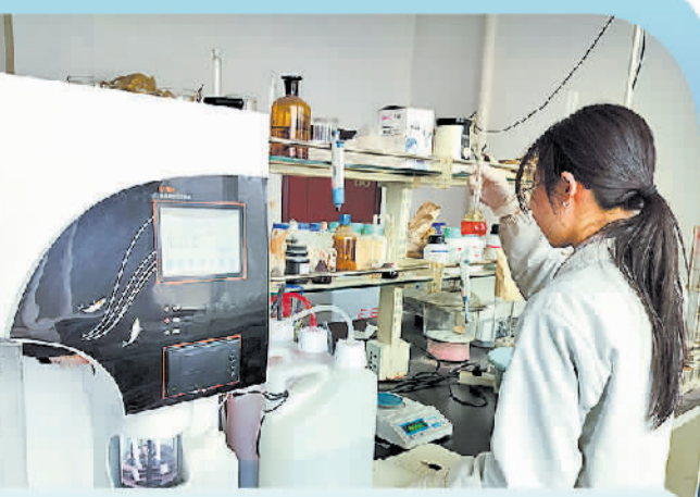
科研人员在中国科学院南皮生态农业试验站植物生理实验室做土壤全氮试验。郭玉培摄
