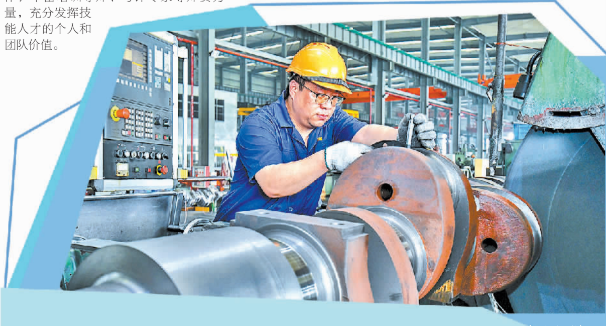
中策集团曲轴加工工段，工程师正在检测曲轴主轴颈。
