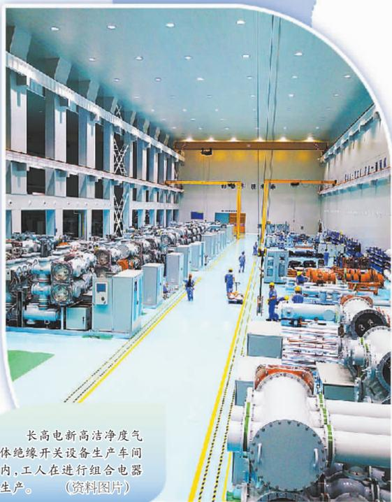
长高电新高净度气体绝缘开关设备生产车间内,工人正在进行组合电器生产。(资料图片)
