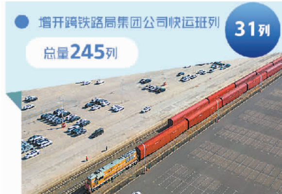
一列JSQ专用车型的中欧班列从哈尔滨国际集装箱中心站出发。JSQ专用车型铁路货车车厢内设有上下两层结构,装运量是传统集装箱的一倍,大大提升装车效率。新华社记者 张涛摄
