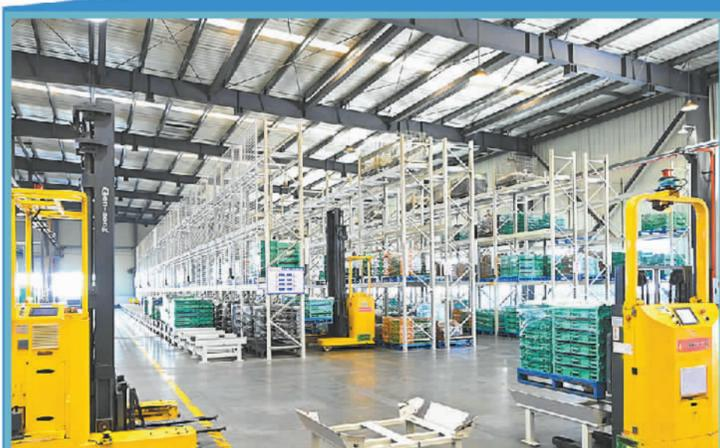
重庆市旺成科技股份有限公司,无人智能搬运AGV机器人搬运齿轮半成品到中转库。孙凯芳摄(中经视觉)
