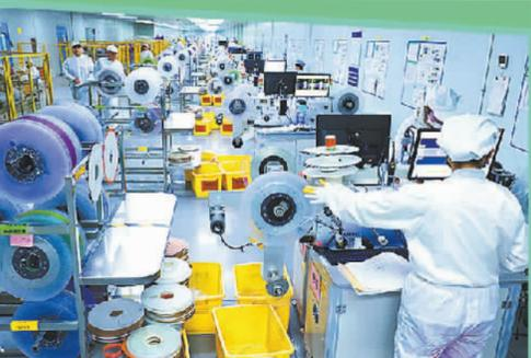
江苏连云港经济技术开发区一家电子科技公司生产车间,工人在锂电池极耳生产线上忙碌。耿玉和摄(中经视觉)
