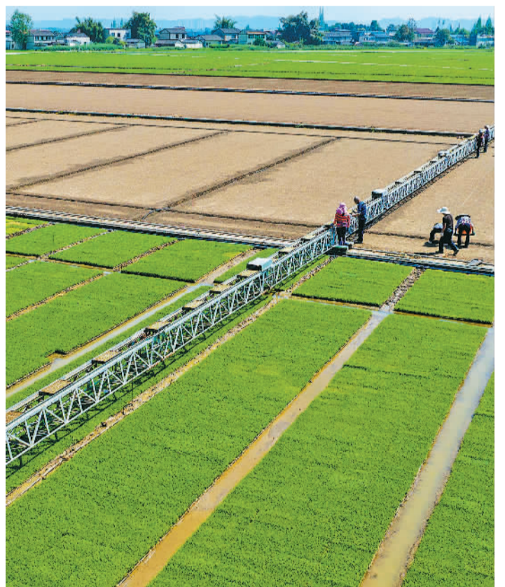
3月28日，四川省眉山市彭山区公义镇欣荣村的数智水稻育秧中心，工人利用机械轨道运送秧盘到田间培育。近年来，当地大力推广数智化育秧，并实现水稻生产全程机械化。
