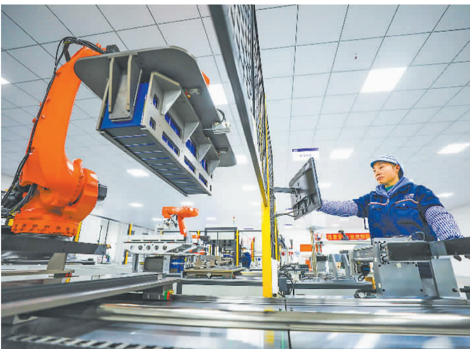
位于江西省抚州市南丰县智能制造产业园的卓阳江西智能工厂，工人在装配锂电池。近年来，当地持续开展“5G+工业互联网”数字化车间、智能生产线、智慧工厂建设，推动制造业数字化、智能化。
