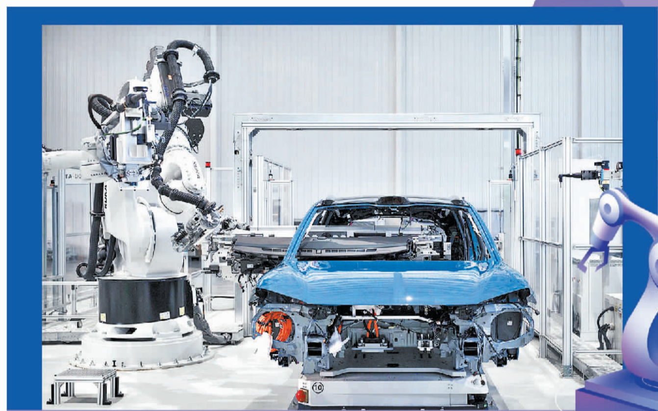
蔚来第二先进制造基地的自动装配岛。
