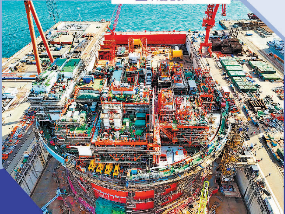
由我国自主设计建造的亚洲首艘圆筒型浮式生产储油装置——中国海油“海洋石油122”已完成主体建造。 张进刚摄(中经视觉)
