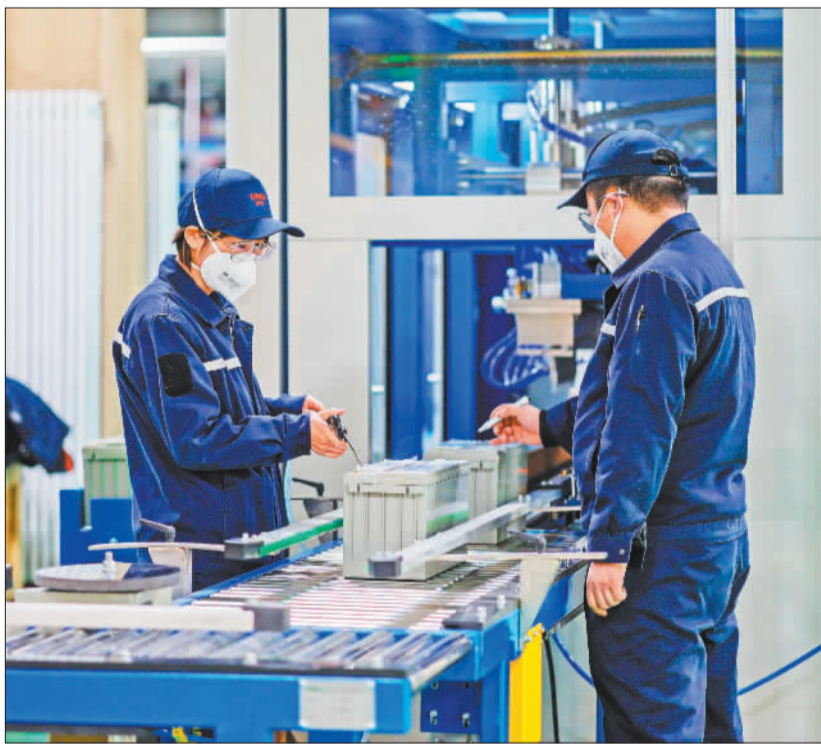
▲白城绿电产业示范园区,吉电能谷(白城)储能投资有限公司,员工在对铅炭电池进行气密性检测。 李晓明摄(中经视觉)
