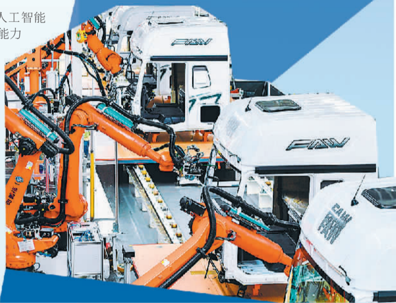
在位于吉林长春的一汽解放J7智能工厂内,智能机器人在进行车辆玻璃装配及涂胶工作。新华社记者 许畅摄
