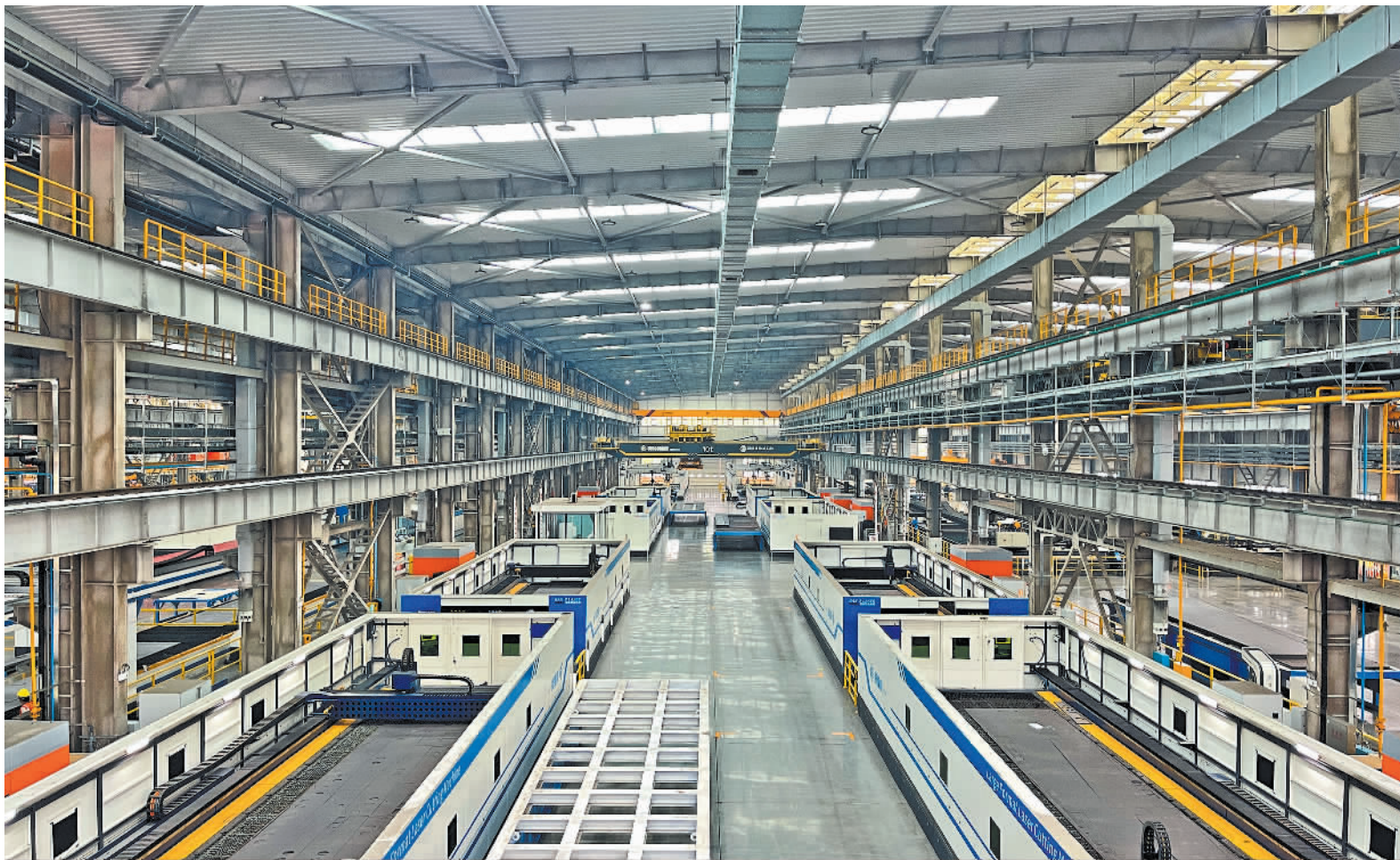
郑煤机集团生产车间内的激光切割生产线。
