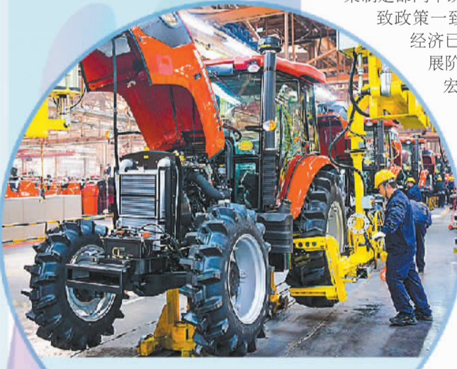
中国一拖大拖公司总装生产线上,工人正在装配拖拉机。
