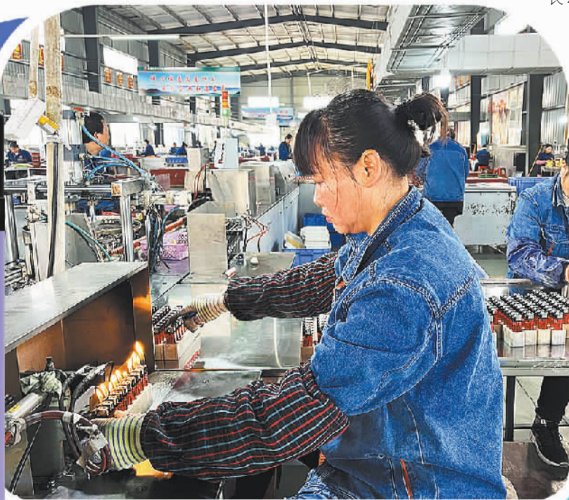
工人正在进行打火机的火焰高度检测。
