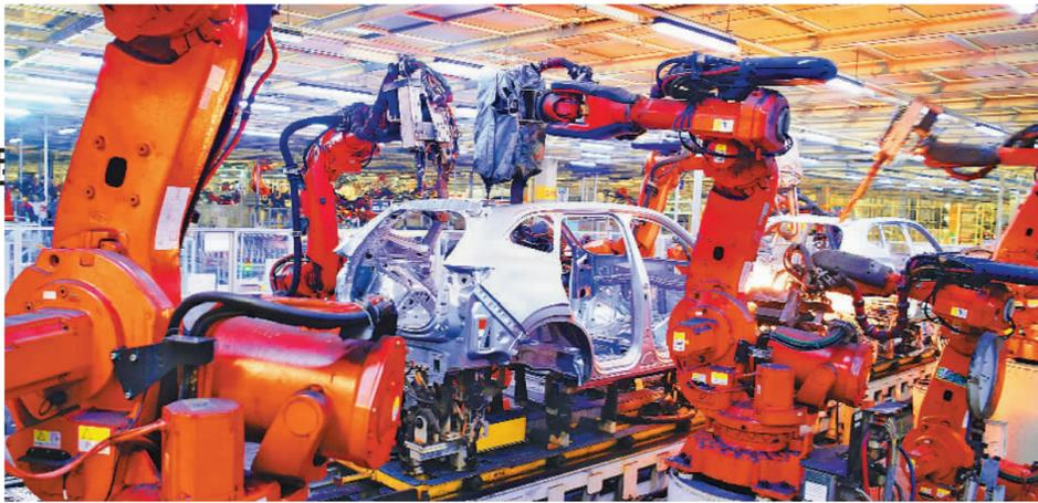
12月1日,河北省保定长城汽车徐水工厂焊接车间,机械臂正在给车身顶盖焊接作业。近年来,保定市相继出台了《保定市新能源汽车产业发展规划》等相关政策措施,全力创建全球领先的“新能源+智能网联”汽车产业创新集聚区,打造国内一流的新能源及智能网联汽车产业示范基地。郭 卉摄(中经视觉)
