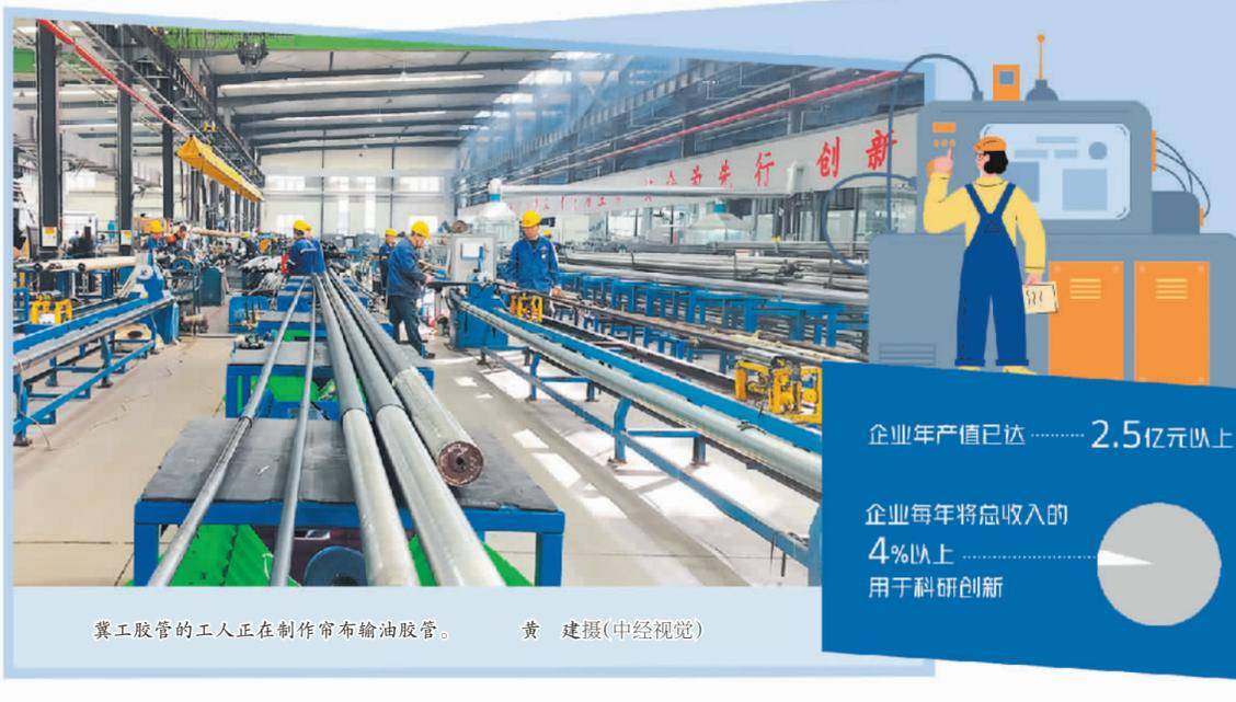
冀工胶管的工人正在制作帘布输油胶管。 黄建摄(中经视觉)
