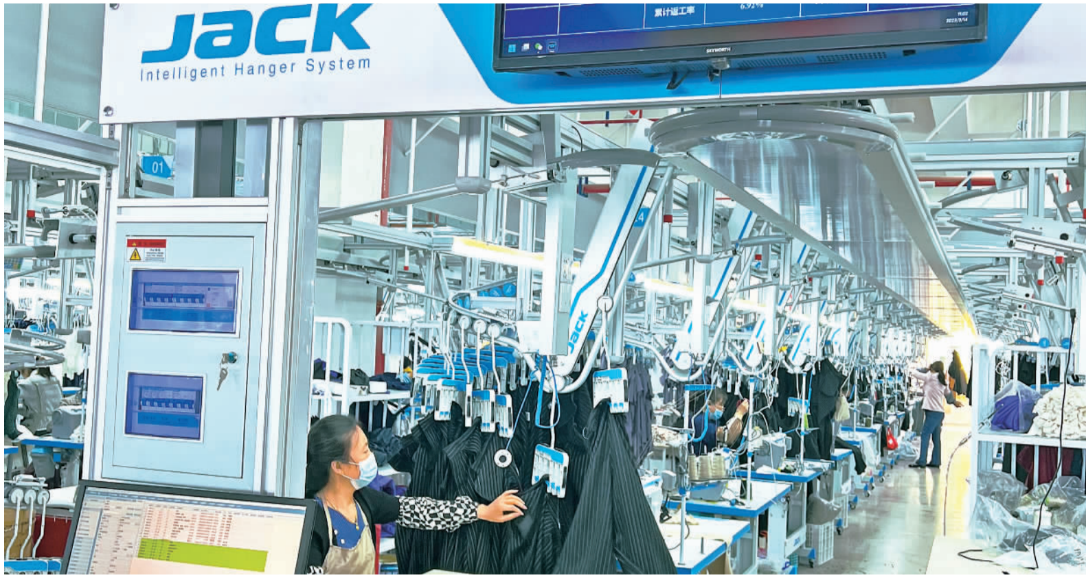
位于江西于都的翦侖文德时装股份有限公司,智能缝制吊挂车间里安装了服装吊挂系统,能够快速将布料送至工人的操作台前。据介绍,每种布料都配有专属芯片,工人操作前会扫码。
