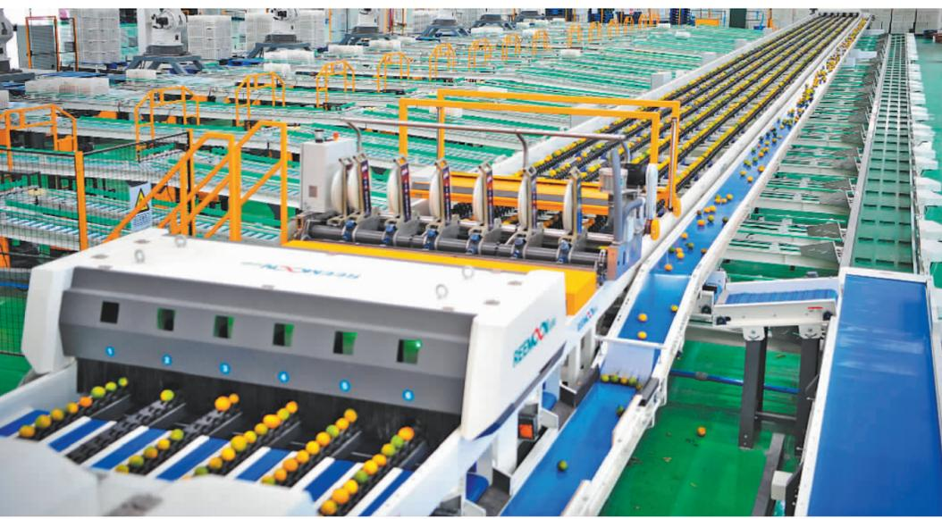
位于湖北省宜昌市夷陵区国家现代农业产业园的“柑橘5.0智能分选生产线”日前正式投产,能够精准识别柑橘的糖度、水分及果肉损伤情况,并对柑橘表皮的瑕疵、色泽、果径大小进行精细化分选后装箱。目前,该产业园已实现柑橘产业链全覆盖。
