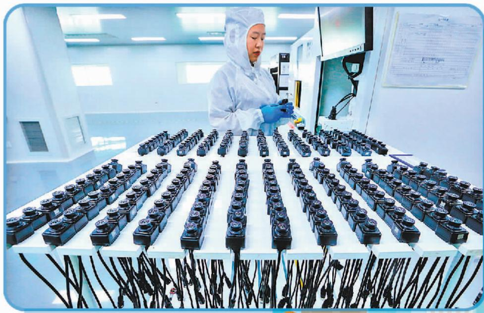
青岛即东汽车零部件有限公司车间内,工人在对车载摄像头进行气密性检测。梁孝鹏摄(中经视觉)
