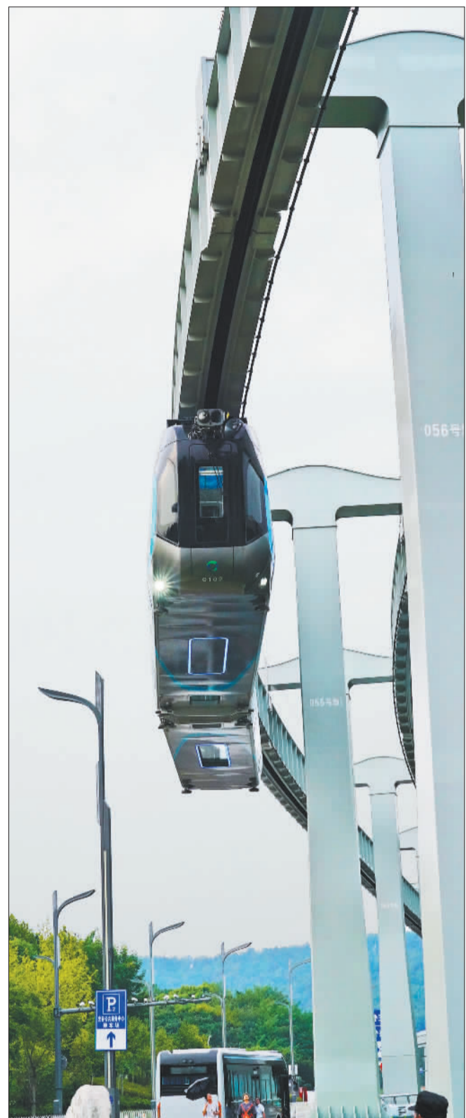
位于武汉东湖高新区的“光谷光子号”空轨正在空载试运行。这是国内首条空中悬挂式列车，目前已开通运营。这种智能化程度高，可实现智能感知、智能行车并具备无人驾驶功能的交通工具，为城市带来前所未有的创新体验。
