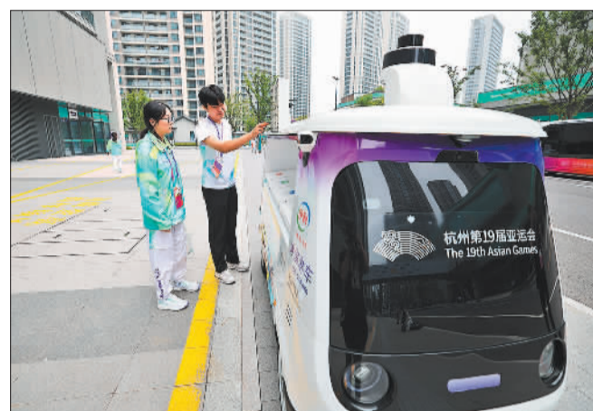
▲杭州亚运村的无人驾驶智能巴士搭载的30° 800万像素相机，可感知600米范围内的车辆和300米范围内的行人，并自动规划、实施避让方案。乘客通过车窗可以看到车外虚实结合的互动体验。
