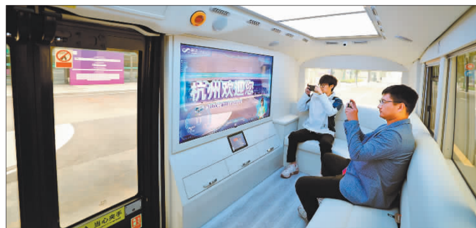
▲杭州亚运村的无人驾驶智能巴士搭载的30° 800万像素相机，可感知600米范围内的车辆和300米范围内的行人，并自动规划、实施避让方案。乘客通过车窗可以看到车外虚实结合的互动体验。
