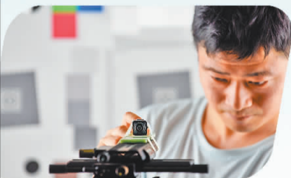
合肥晟泰克汽车电子股份有限公司技术人员正在对智能驾驶辅助摄像头进行图像性能测试
