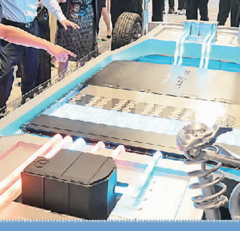
宁德时代发布的种行超充电池是全球首款采用磷酸铁锂材料的4C超充电池，可达到700公里以上的续航里程。新华社记者 林晔摄
