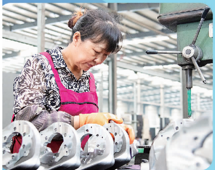
全鑫公司生产车间内,工人在对球颈接管进行外观检验。 黎文来摄(中经视觉)
