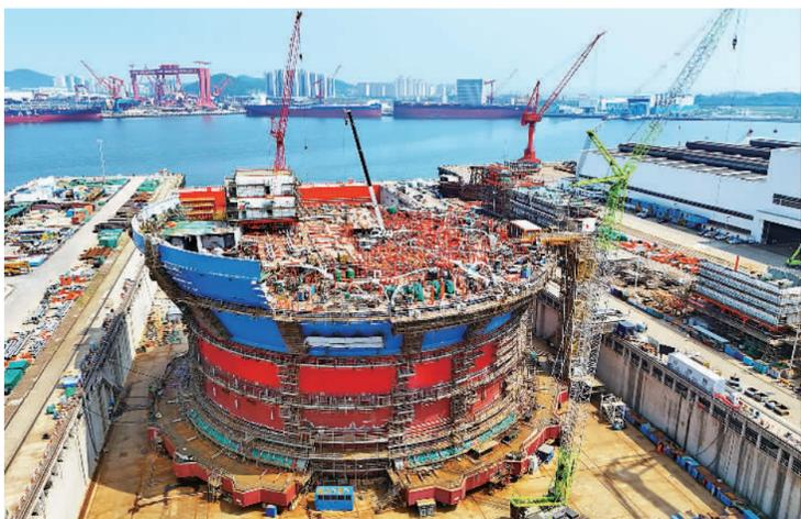
近日,由我国自主设计建造的亚洲首艘圆筒型“海上油气加工厂”——“海洋石油122”浮式生产储卸油装置在青岛西海岸新区完成船体建造,标志着我国深水超大型装备研发制造能力实现新突破。 张进刚摄(中经视觉)
