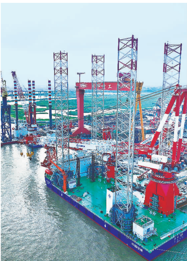
8月8日，在振华南通重装备码头拍摄的中交海峰2500吨自升自航式风电安装平台“海峰1001”。当日，“海峰1001”顺利完成为期两天的全程抬升拔桩试验。该平台主要用于15兆瓦及以上机组设备安装，可同时运载2套15兆瓦风机机组设备。许丛军摄(新华社发)
