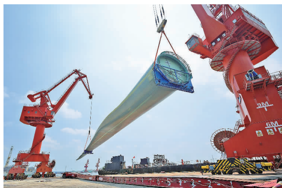
8月4日，由中国东方电气风电股份有限公司研制、拥有完全自主知识产权的B1260A型超大型海上风电叶片在山东烟台港蓬莱港区完成接卸，并将在蓬莱进行多项性能测试。据介绍，该叶片长达126米，是目前全球已下线的最长风电叶片。唐克摄(中经视觉)
