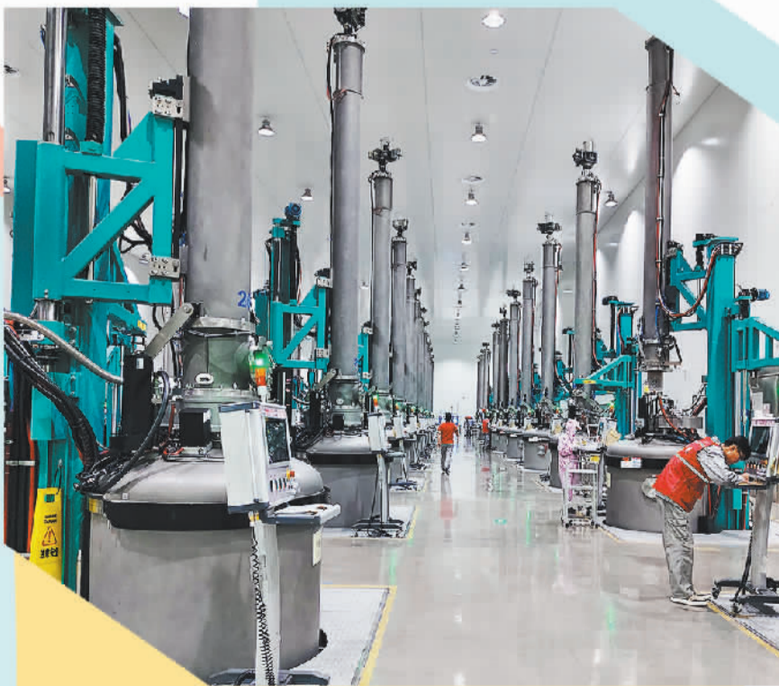
曲靖阳光新能源股份有限公司单晶硅棒生产车间。本报记者 曹松摄
