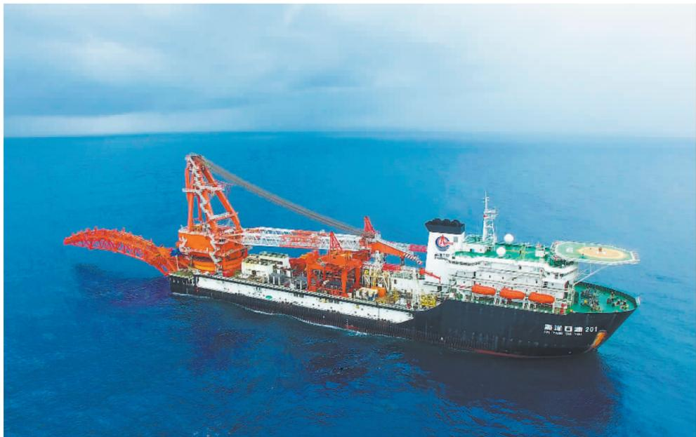
6月22日,在海南陵水海域,“深海一号”大气田二期工程的关键控制性工程——直径20英寸、总长度约115千米的海底油气长输管道铺设完工,标志着我国深水长输海底管道建设能力和深水装备技术实现重要突破。这是22日拍摄的亚洲首艘3000米级深水铺管起重船“海洋石油201”。
