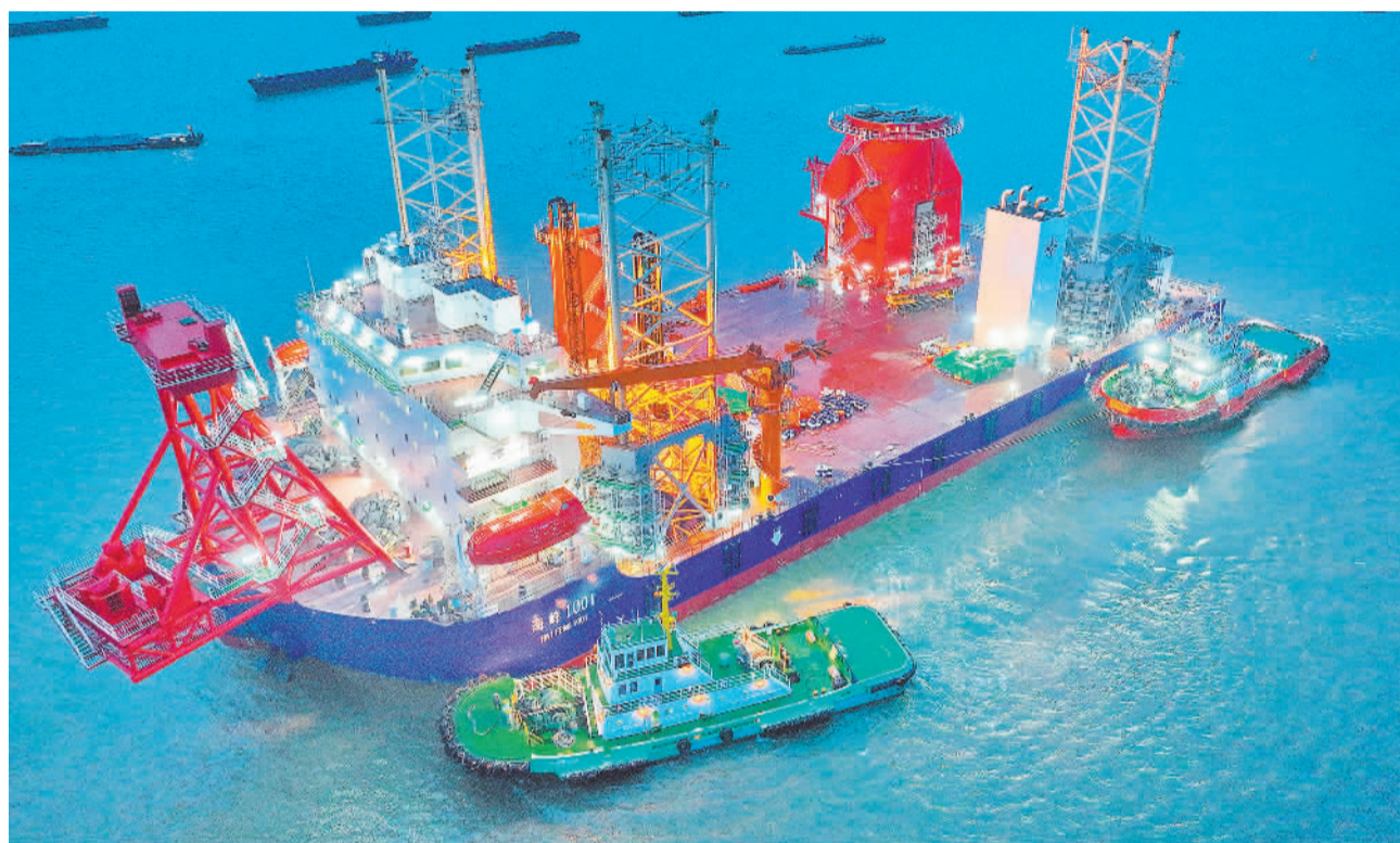
6月5日,由上海振华重工完全自主设计、建造,目前国内起重能力最大的自升自航式风电安装平台“海峰1001”顺利出坞。项目建成后适用于砂性土或类似地质作业,将在海上风电施工领域产生深远影响。 许丛军摄(中经视觉)
