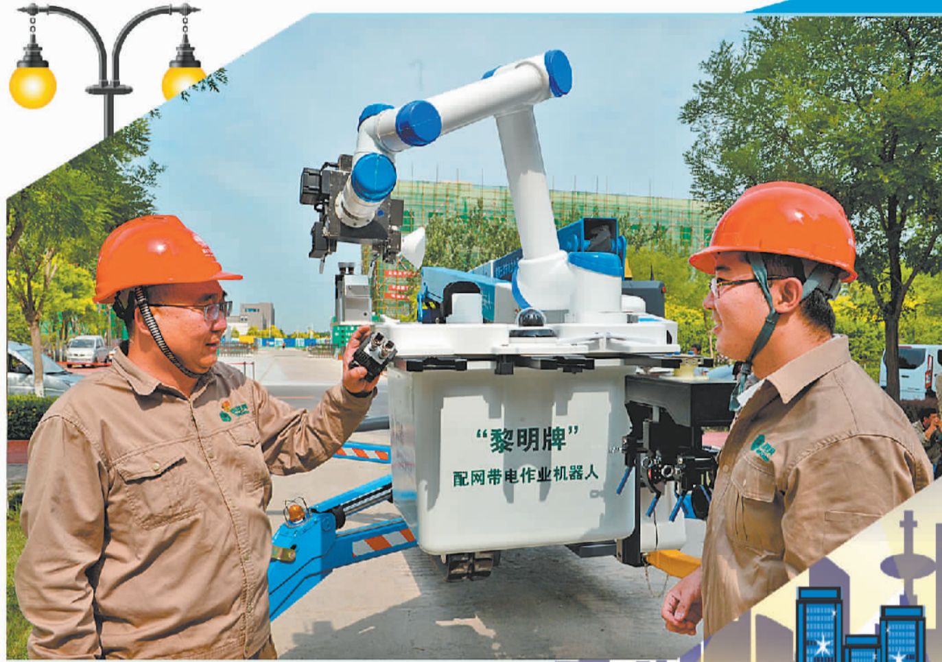
张黎明(左)与徒弟在现场研讨第四代配网带电作业机器人的实际作业成效。王立国摄(中经视觉)
