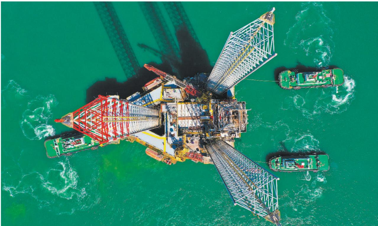
▲4月26日,山东省烟台市中集来福士建造基地,完成交付的“湾钻3”号自升式钻井平台在拖轮的牵引下出港。烟台市推进海洋高端制造业发展,打造海工装备自主创新集成基地。
