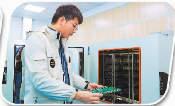
恒烁半导体测试人员设置实验环境,通过可靠性测试,验证芯片性能
