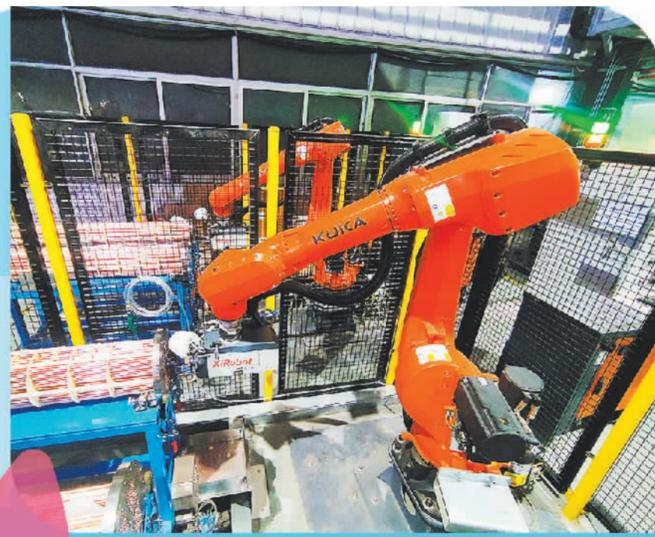
上图 重庆美的通用制冷设备有限公司模块机生产车间,机器人在进行胀管操作。
