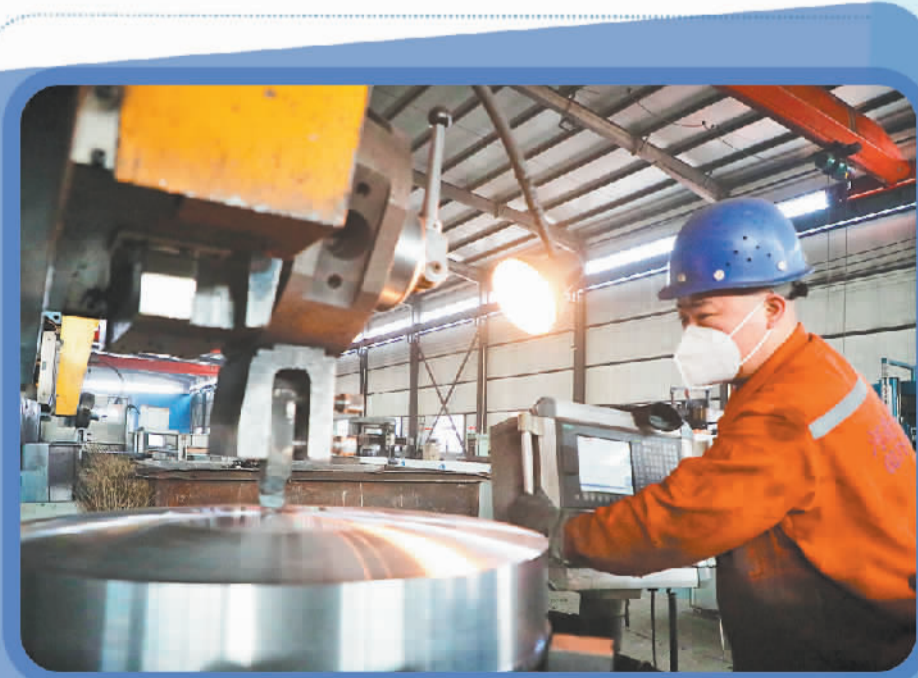
衡水宏祥桥梁工程材料科技有限公司工人在操控立式车床加工桥梁支座。
