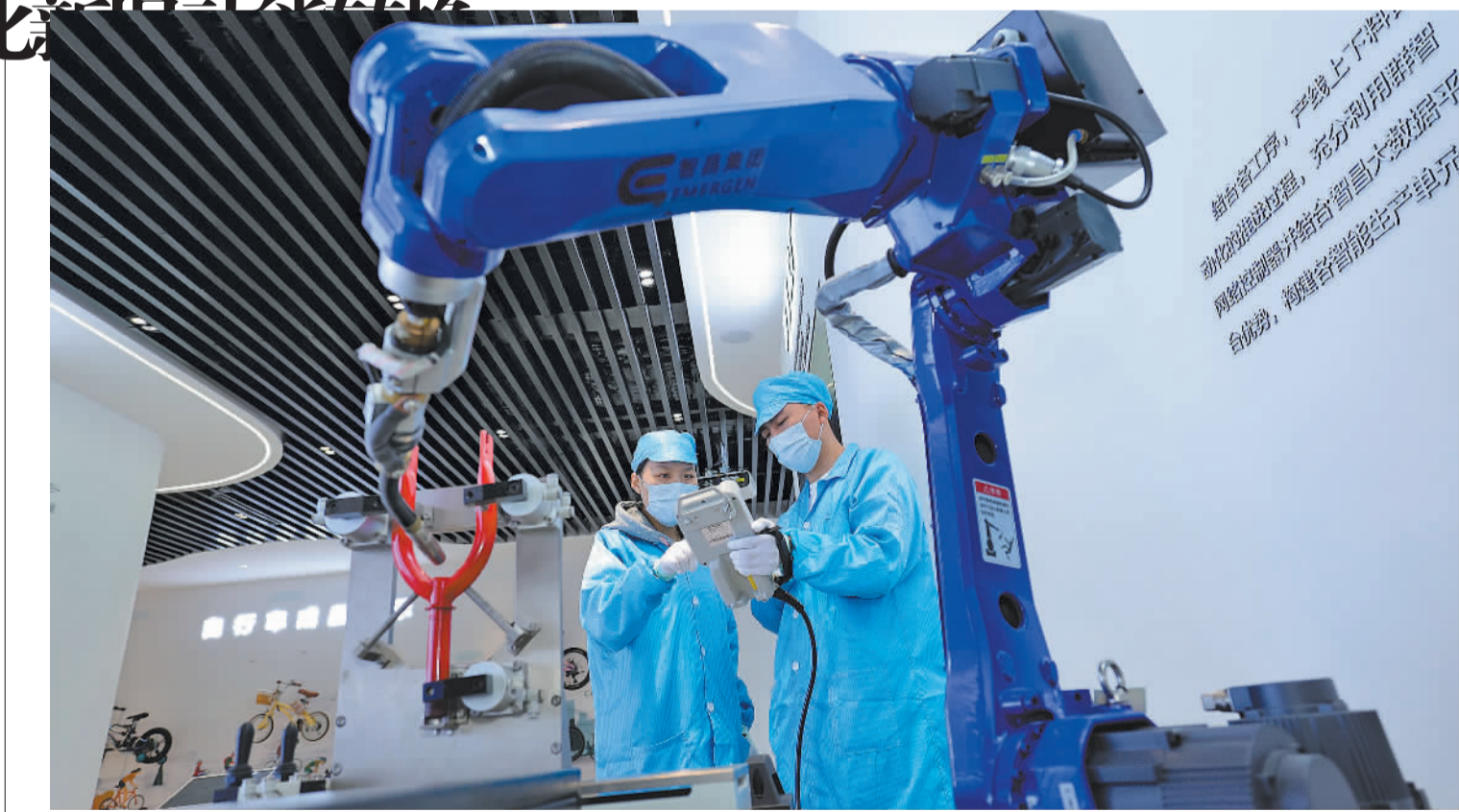
3月28日，河北省邢台市平乡县童车产业数字化示范基地，工作人员对单臂焊接机器人进行编程作业。近年来，平乡采取产业智联平台+智能共享工厂模式，加快数字化转型升级，推动经济高质量发展。
