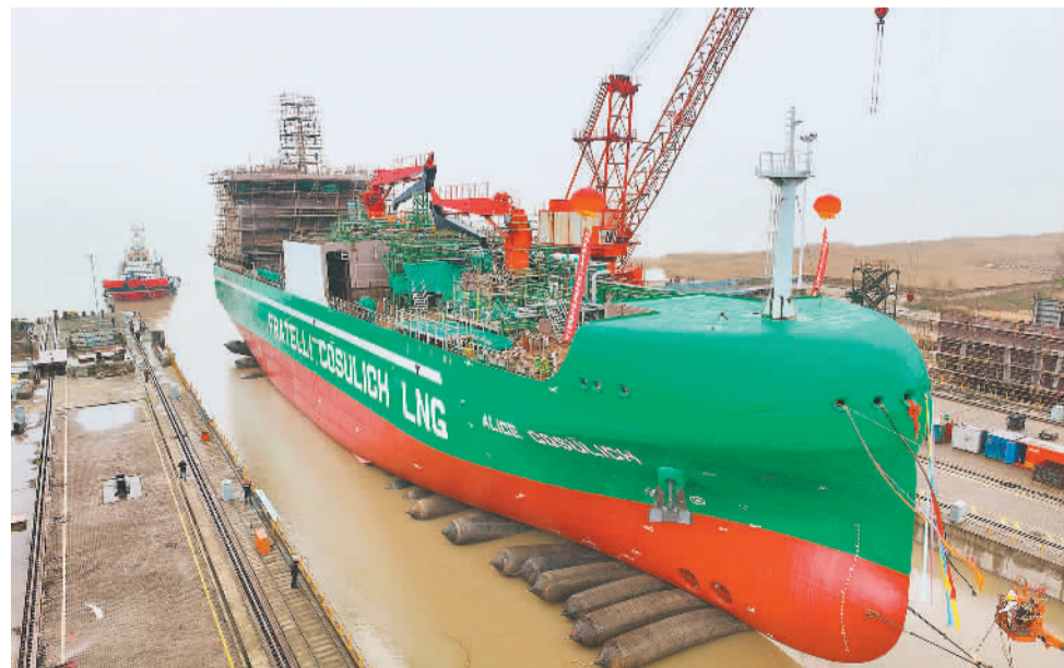
3月22日,由中集太平洋海工建造的8200立方米LNG加注船首制船(S1058),在江苏启东海工船舶工业园下水。该系列船采用先进的电力推进方案,运行经济、节能、环保。
