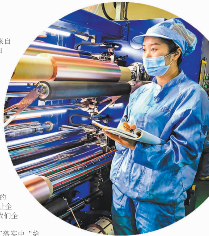
位于铜陵经开区的铜陵冠冠电子铜箔有限责任公司分切车间，工人正在仔细检查成品切边、铜箔表面等外观并做好巡检记录
