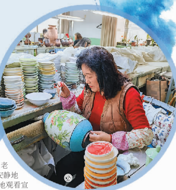
图② 在北京珐琅厂车间,技术工人正在点蓝。 本报记者 杨学聪摄
