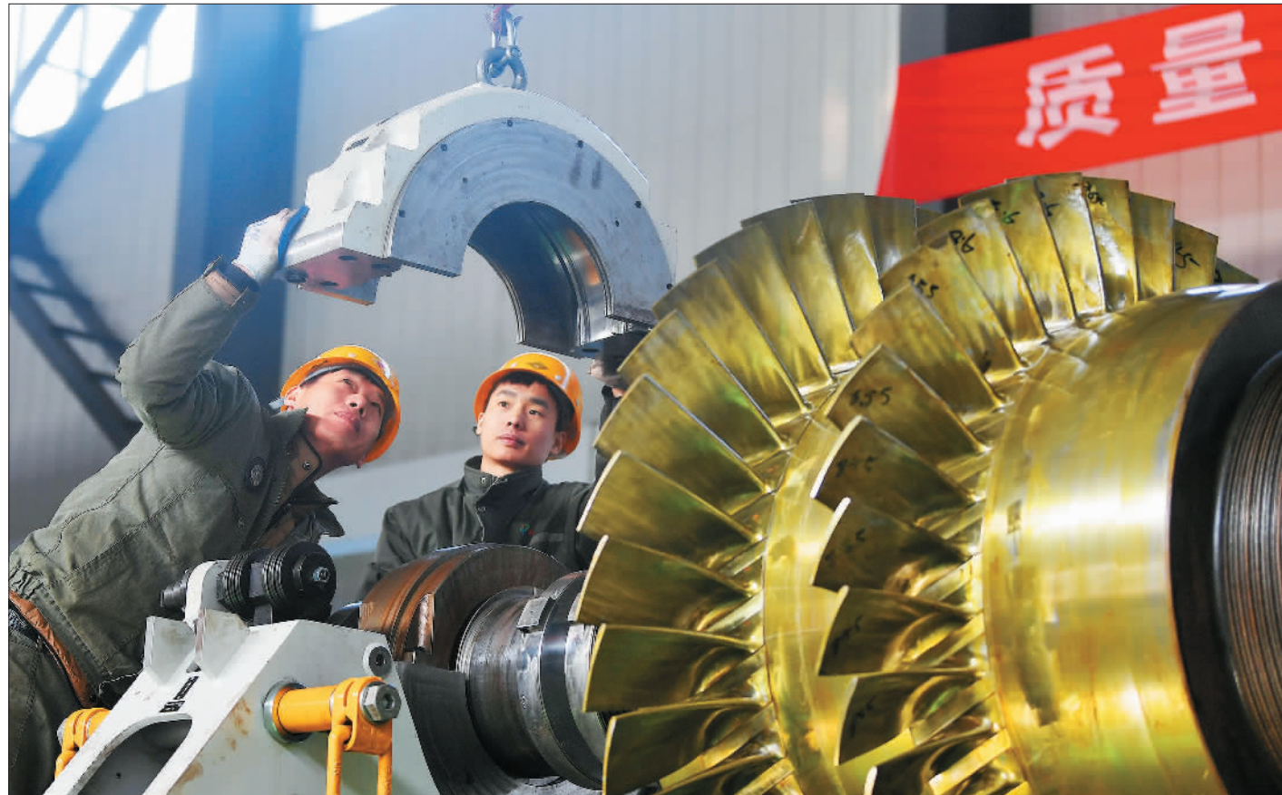
◀位于迁安经济开发区的河北迁控科源透平设备有限公司,员工正在进行高速动平衡检测。迁安市精品钢铁、装备制造业产业集群发展迅速,跻身国家新型工业化产业示范基地。
