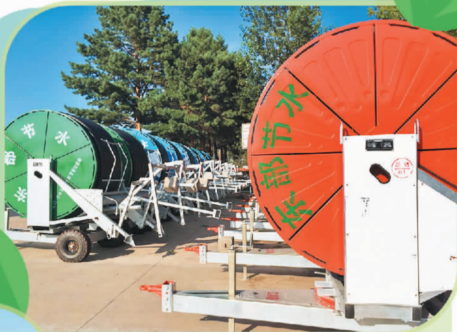
上图 东水集团生产的卷盘式喷灌机。(资料照片)
